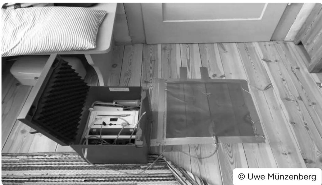
**Blick auf eine typische Messsituation, bei der mittels des sogenannten Radon-Sniffen bei Unterdruck geprüft wird, durch welche Bauteile Radon aus dem Untergrund in die Wohnräume gelangt.**
