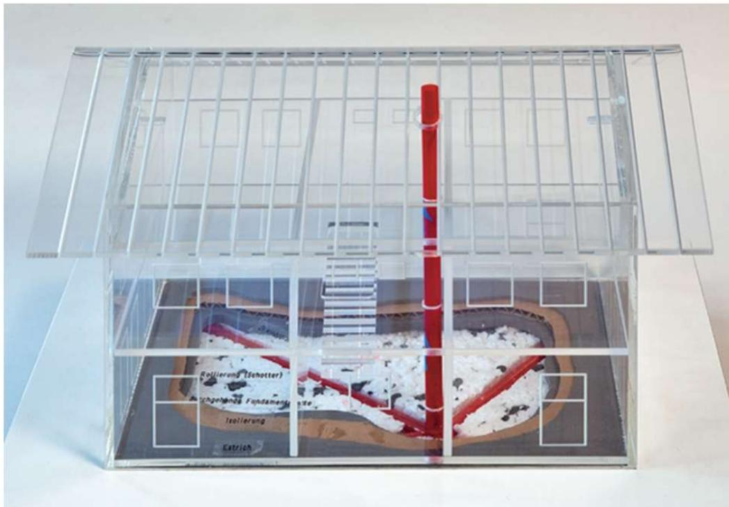
Abbildung 13: Radondrainage mit Abluftleitung über Dach
